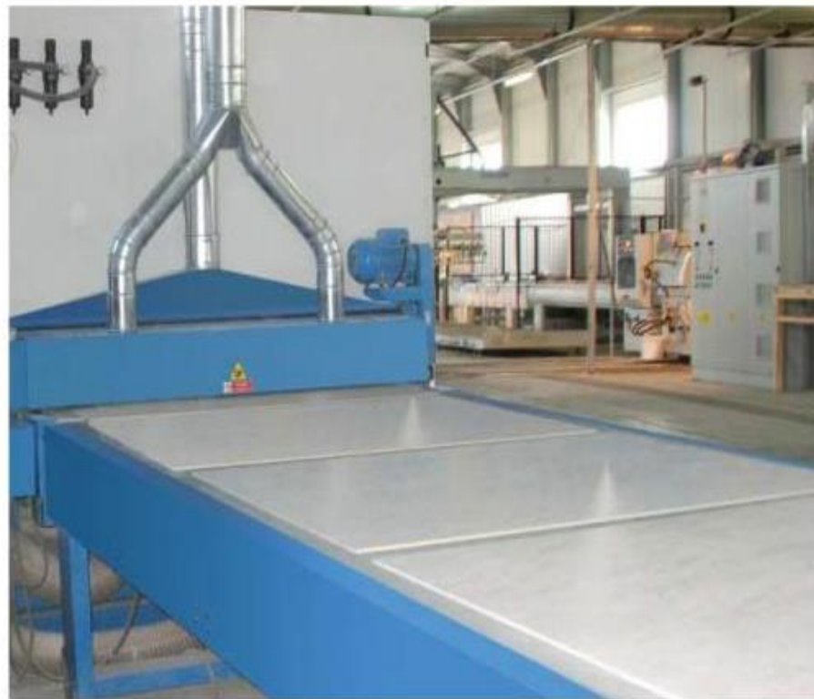
Шлифование фиброцементных плит
